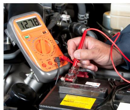
Bien sûr, le modèle récents de batteries possède une lentille sur le dessus indiquant leur état de chargement : Vert si OK et Rouge si déchargée. Ce témoin n'indiquera pas la tension de la batterie, il est donc essentiel de tester votre batterie au préalable : celle-ci est peut-être encore rechargeable. Une aubaine si votre budget actuel ne vous permet pas un achat.
